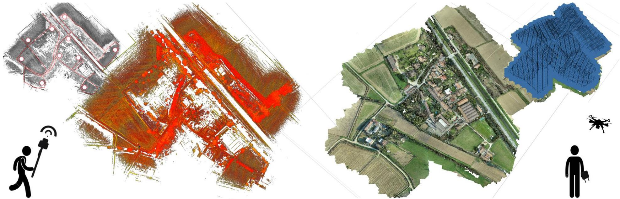
Campagna di acquisizione estensiva, con MLS e UAVs per la costruzione di un duplicato digitale dell'area oggetto di indagine, su cui sviluppare considerazioni e analisi sul paesaggio agricolo e sul suo reticolo geometrico di canalizzazioni.
